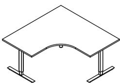
Schreibtisch mit Freiformplatte, T-Fußgestell mit manueller Höheneinstellung, Plattendicke 28 mm
